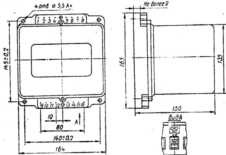
Рис. 1. Габаритные и установочные размеры реле BC-10-31+38
