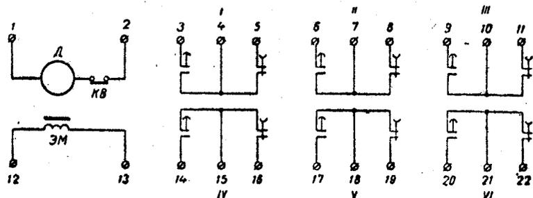
Рис. 6. Электрическая схема реле BC-10-62+68:
